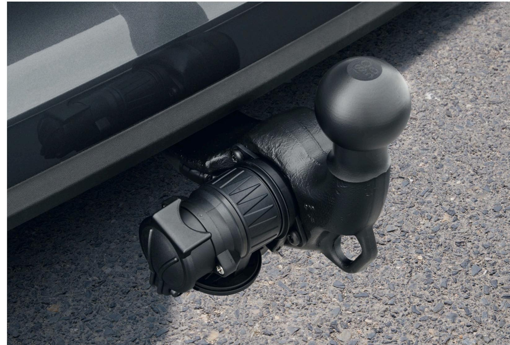
**Adaptador de enganche de remolque: de conector de 13 pines a conector de 7 pines**
